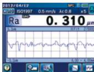
Zobrazenie profilu: jeden parameter výsledku meraní a nameraný profil
