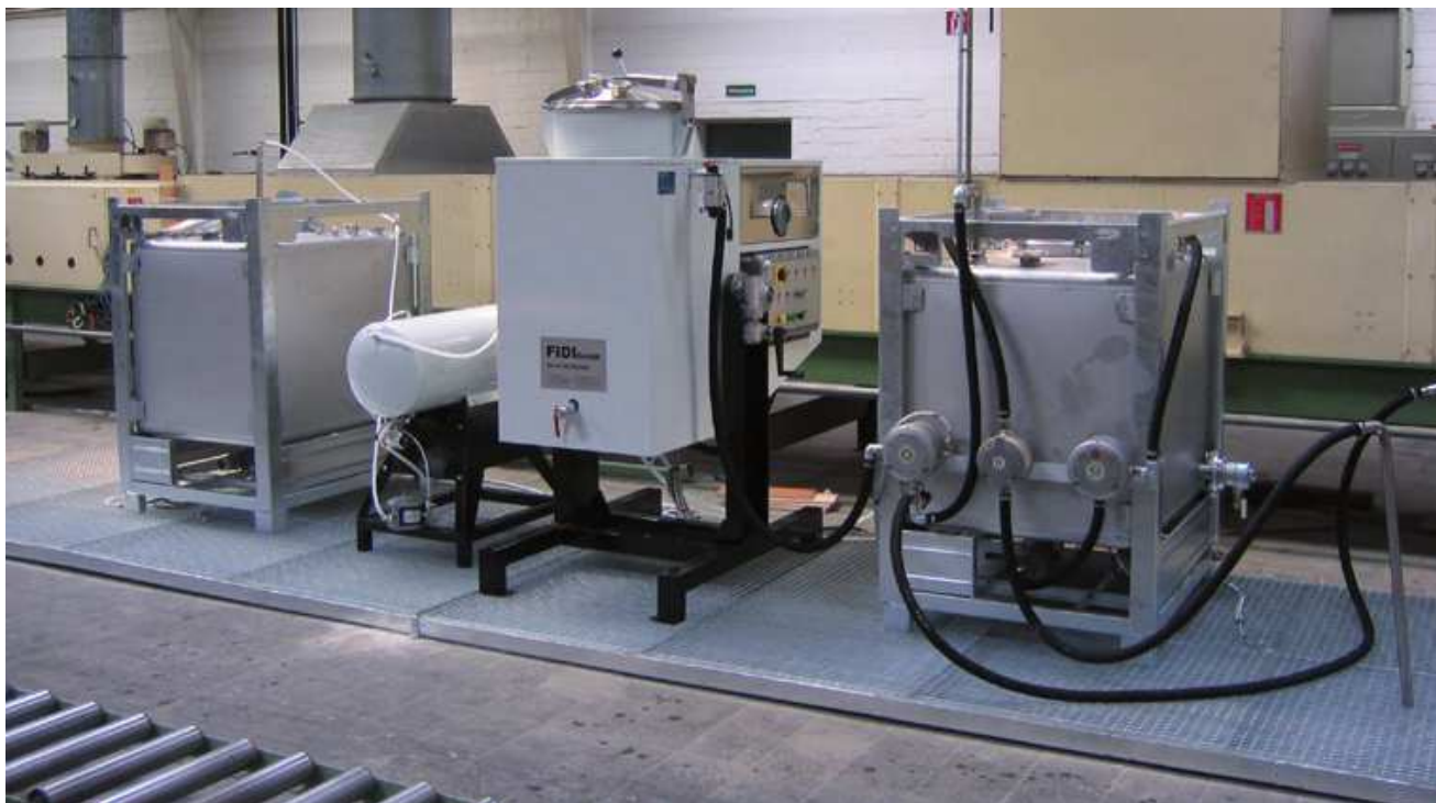
Kombinácia destilačného zariadenia s nádržami pre znečistené a čisté rozpúšťadlo
